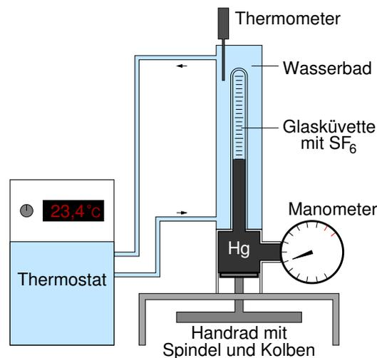
Abbildung 4: Versuchsaufbau
